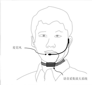
图2 口内微音器型电子人工喉佩戴效果示意图
